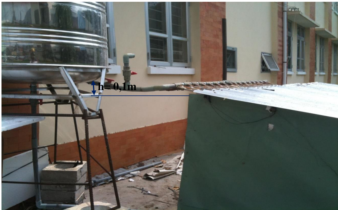
Hình 12. ống thu nhiệt dưới tole và \alpha = 5,7^\circ , h = 0,1\text{m}
