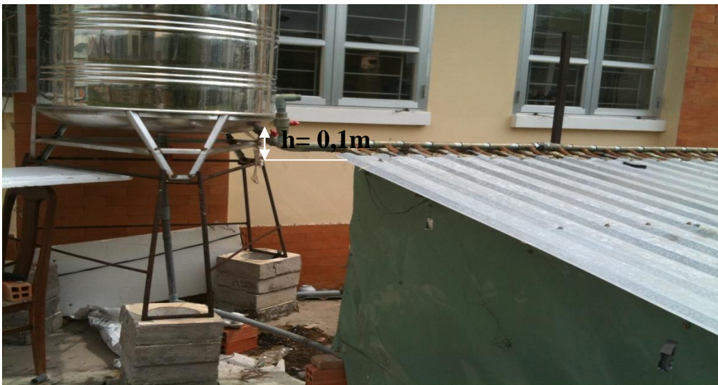
Hình 16. Ống thu nhiệt dưới tole và \alpha = 6,8^\circ – h = 0,1m
