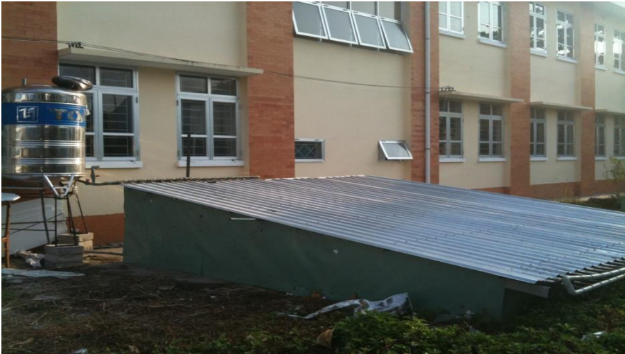
Hình 10. Ống thu nhiệt nằm dưới tole và \alpha = 5,7^\circ , h = 0
